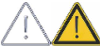
Auf dem Gerät ist das grafische Symbol "Gefahrenstelle" aufgebracht. Mit diesem Symbol wird vor einer möglichen Gefahrenstelle an dem Gerät gewarnt, von der eine drohende oder unmittelbar drohende Gefahren für das Leben und die Gesundheit von Personen ausgehen kann.
